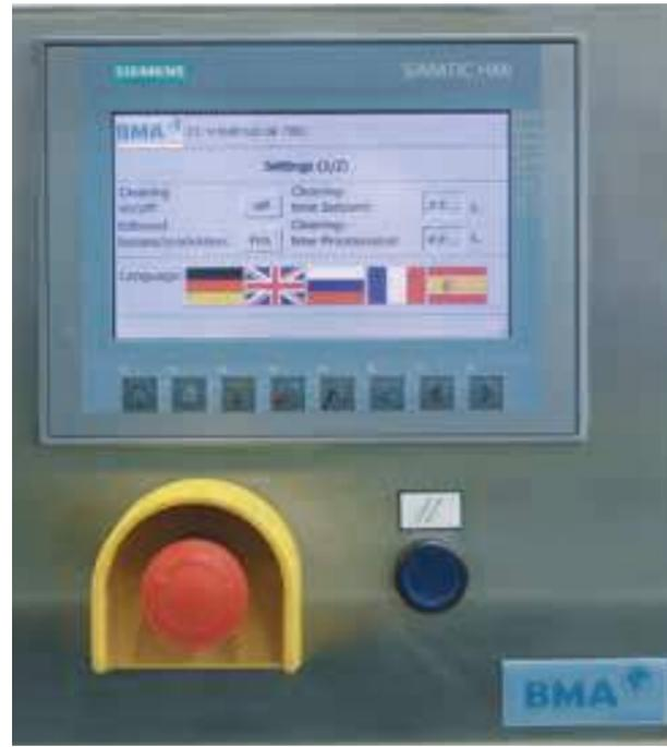
Ajuste perfecto: control de centrífuga basado en componentes de Siemens o de Allen-Bradley
